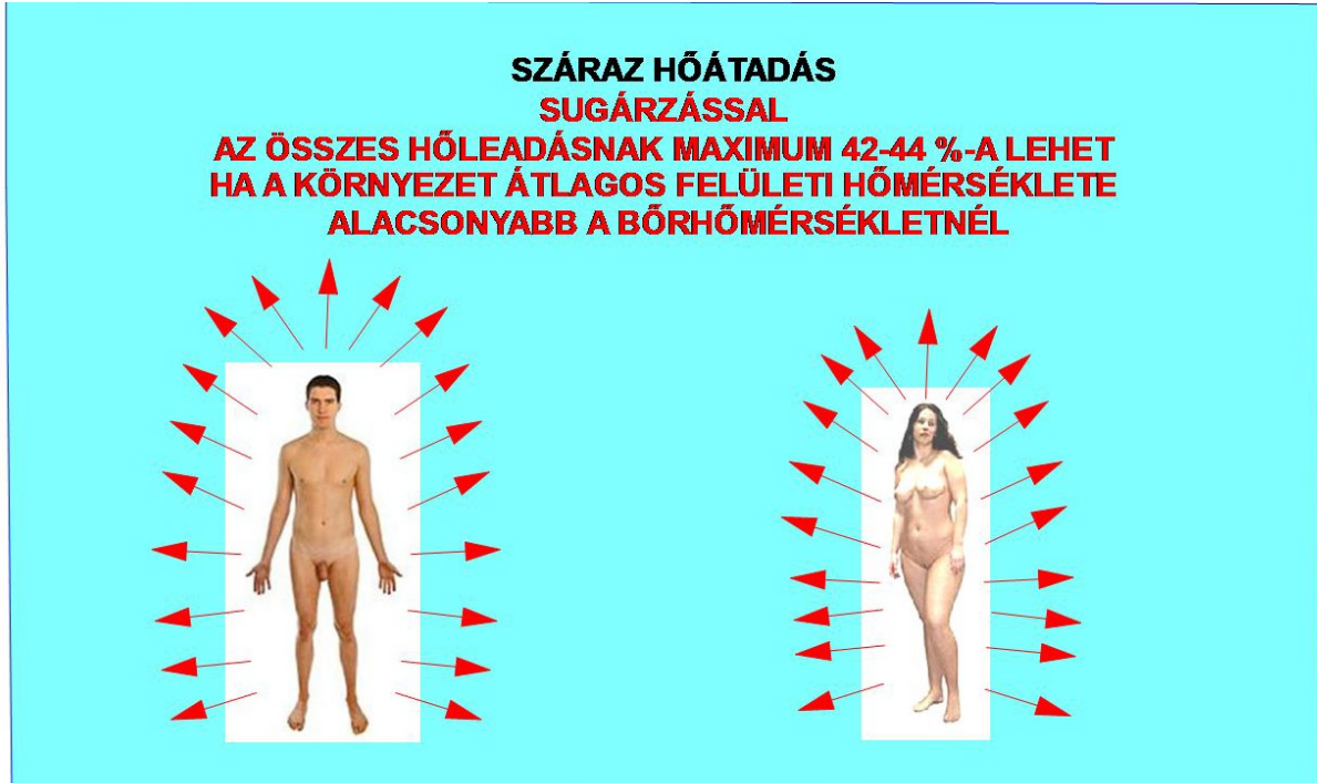
7. sz. ábra SZÁRAZ HŐCSERE SUGÁRZÁSSAL
