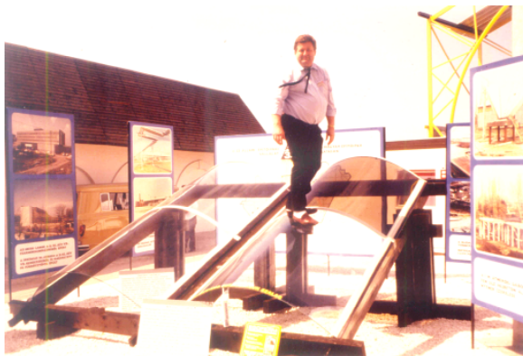
82. sz. ábra PRÓBATERHELÉS A 140 kg SÚLYÚ EMBERREL A 150 CM FESZTÁVÚ ÜVEGDONGA FELÜLVILÁGÍTÓN
