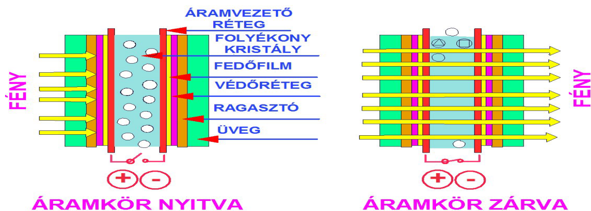
77.sz. ábra FOLYÉKONY KRISTÁLY SZERSZERKEZETÉNEK RENDEZŐDÉSE ELEKTROMOS FESZÜLTÉG HATÁSÁRA
