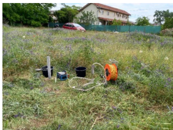
9. kép: Mintavétel a kiépített monitoring kutakkal
