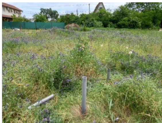
8. kép: Kiépített talajvíz monitoring kutak (3 db)
